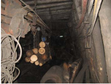
Slika 1: Suženje profila zbog materijala i opreme u prostoriji
