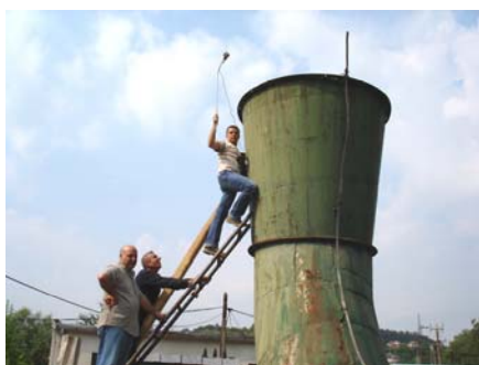
Slika 2: Mjerenje brzine vazduha na difuzoru ventilatora
