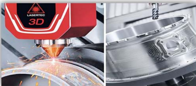
Slika 4. Kombinacija LENS postupka i procesa glodanja na hibridnoj mašini DMG MORI Lasertec 65 3D [8]
