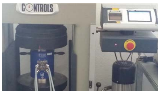
Slika 6. Položaj četverokanalne mjerne ćelije u presi za ispitivanje očvrslag betona od 3000 kN
