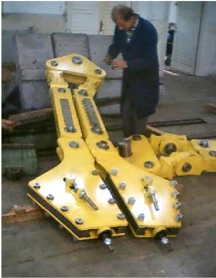
Slika 3. Vizuelno ispitivanje spojnog pribora izvoznog postrojenja
