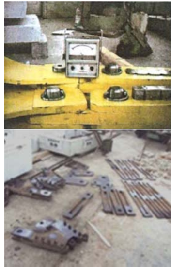
Slika 3. Vizuelno ispitivanje spojnog pribora izvoznog postrojenja
