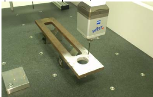
Slika 4. Dimenziona kontrola ovjesne poluge I spojnog pribora
