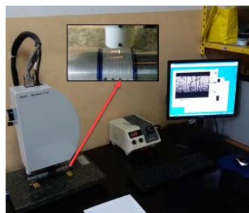
Slika 2. Prikupljanje podataka - Marsurf TS50
