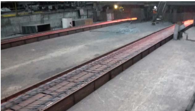
Slika 2. Proces hlađenja namotaja na transporteru .
