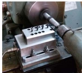
Slika 4. Priprema uzoraka struganjem [1]
