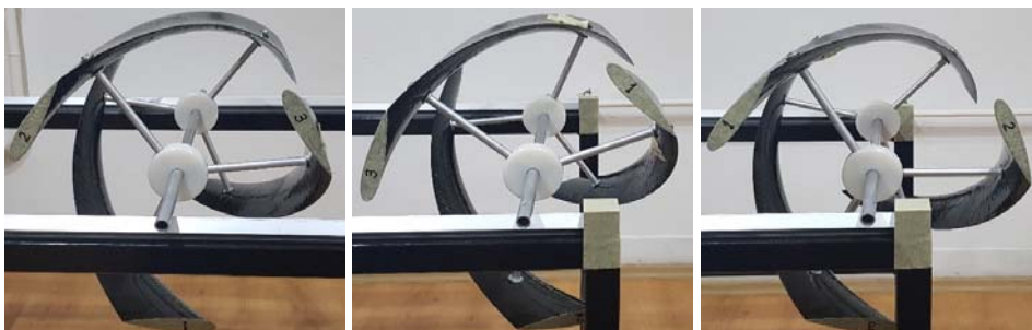
Slika 6. Tri različita položaja u kojima se zaustavio rotor nakon dodavanja masa
