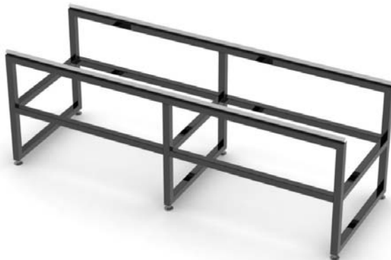
Slika 4. 3D CAD model stola za balansiranje
