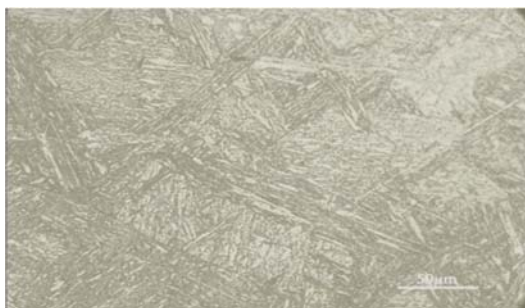
Slika 1. Mikrostruktura martenzitnog nerđajućeg čelika.
