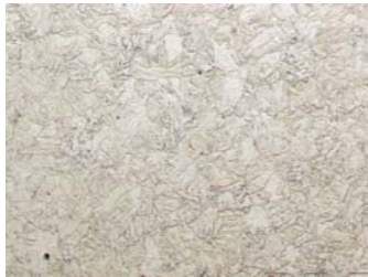
Slika 3. Mikrostruktura čelika 23MnB4 hlađenog u vodi, x500
