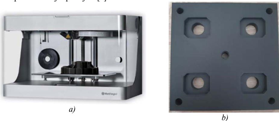
Slika 2. a) 3D printer Markforged Mark Two na kojem je izrađena b) skidačka ploča
