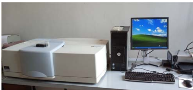
Slika 2. UV-VIS spektrofotometar, PerkinElmer, Lambda 650
