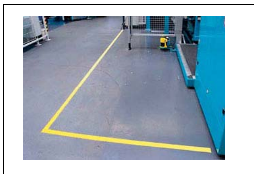
Slika 3. Označavanje radnog prostora bojom
