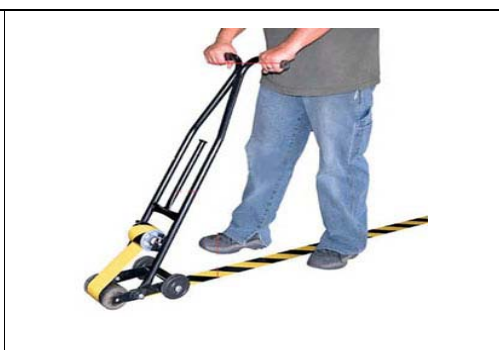
Slika 4. Označavanje radnog prostora trakom
