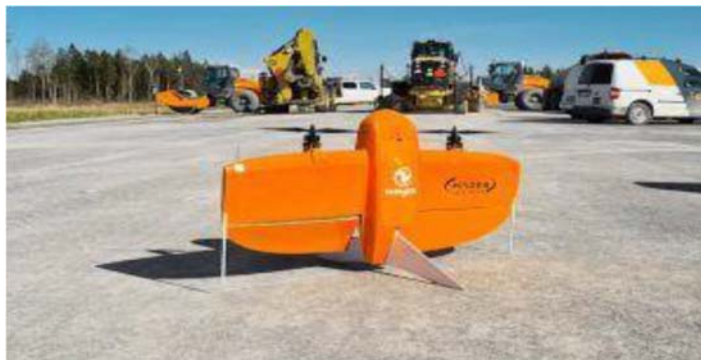
Slika 2. Wingtron dron za snimanje terena
