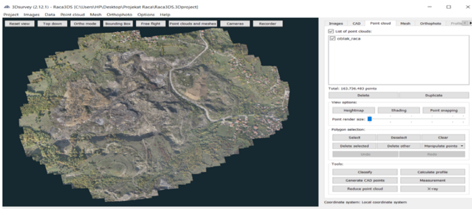
Slika 4. Generisani 3D realni model odlagališta Rača [3]
