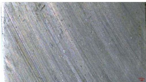
b) rezana dijamantskom reznom pločom, čelik
