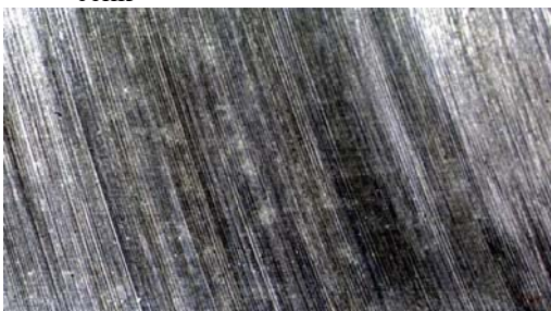
d) rezana dijamantskom reznom pločom, legura Mg
