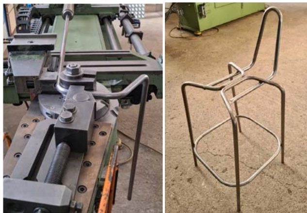
Slika 5. Savijanje cijevi (lijevo) i finalni izgled metalnog dijela barske stolice (desno)
