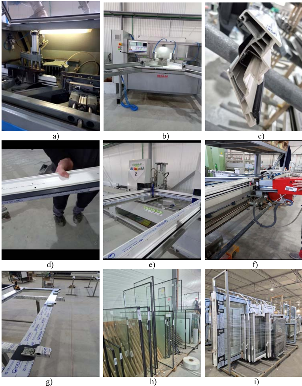
Slika 2. Osnovne tehnološke faze izrade PVC stolarije
