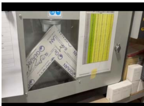
Slika 4. Ispitivanje profila na lom
