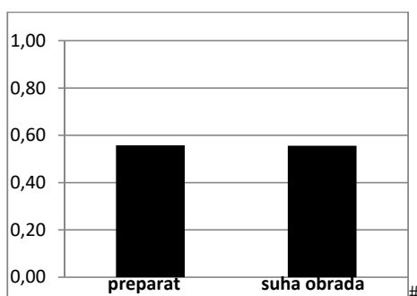
Slika 3. Dijagram maksimalnih koeficijenata trenja pri obradi s preparatom i suhoj obradi U pogledu hrapavosti, Ra je nešto više rezultate ostvarila pri upotrebi preparata, dok su za ostale parametre više vrijednosti ostvarene pri suhoj obradi.
