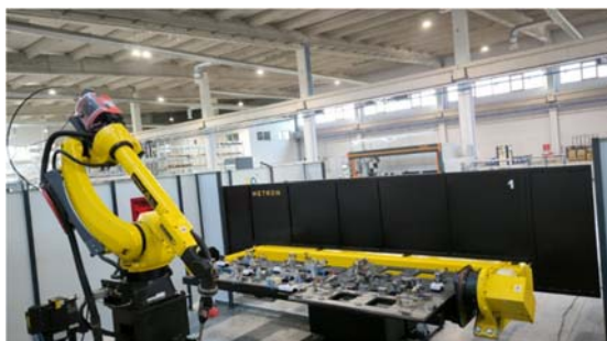
Slika 5. Čelija za zavarivanje aluminijskih barijera pomoću CMT konfiguracije i robotske ruke Fanuc model 120id/12L.
