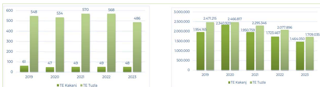
Slika 2. Emisija čvrstih čestica iz TE Tuzla i TE Kakanj za period 2019. – 2023. godina (t) i emisija CO 2 iz TE Tuzla i TE Kakanj za period 2019. – 2023. godina
