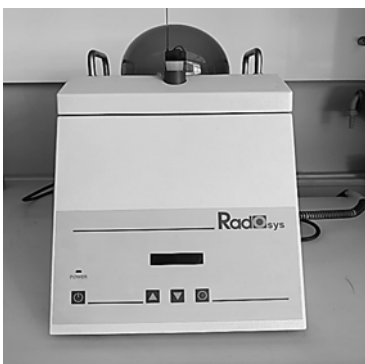
Slika 2. a) RadoBath RB4, termostatirano kupatilo za hemijsko nagrizanje detektora, b) Mikroskop za očitavanje detektora
