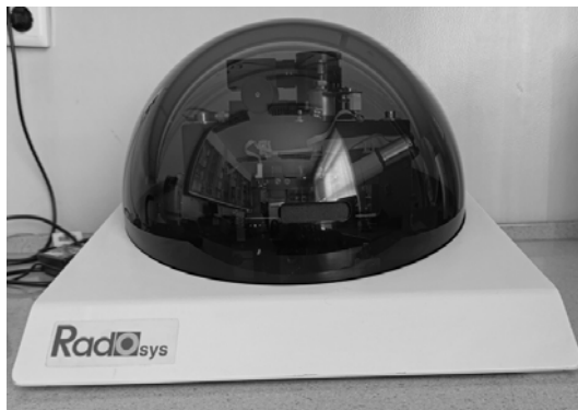
Slika 2. a) RadoBath RB4, termostatirano kupatilo za hemijsko nagrizanje detektora, b) Mikroskop za očitavanje detektora
