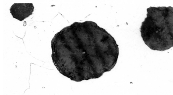
Slika 1. Rezultati metalografskih ispitivanja oblika, tipa, rasporeda i veličine grafitnih uključaka u NL iz proizvedenih vrsta gvožđa (nenagriženo, povećanjem 500X)
