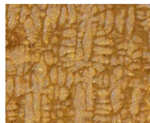
Slika 7. Uzorak 3 – 1: Izgled dendrita u centralnoj zoni, x50
