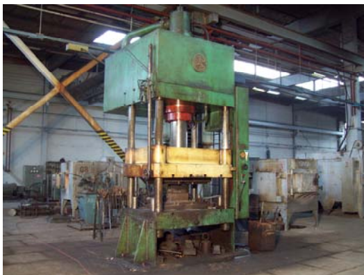
Slika 8: Hidraulična presa (proizvođač: Pitzmann und Pfeiffer-Njemačka, tip PO 200/4)
