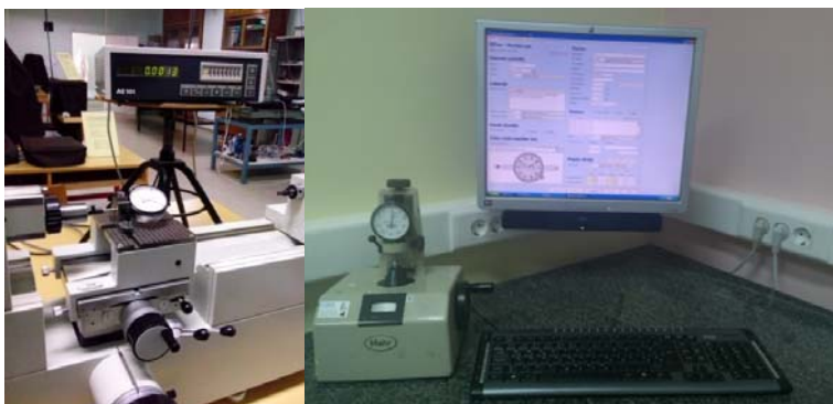
Slika 3. Kalibracija mjernih satova na univerzalnoj mjerneoj mašini ULM-01 600C i uređaju za provjeru mjernih satova Carl Mahr 865
