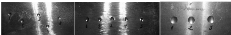
Slika 6. Otisci na ispitanim površinama prilikom mjerenja tvrdoće
