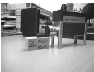
Slika 5. Postupak mjerenja hrapavosti površine na uređaju Perthometer M1[3].
