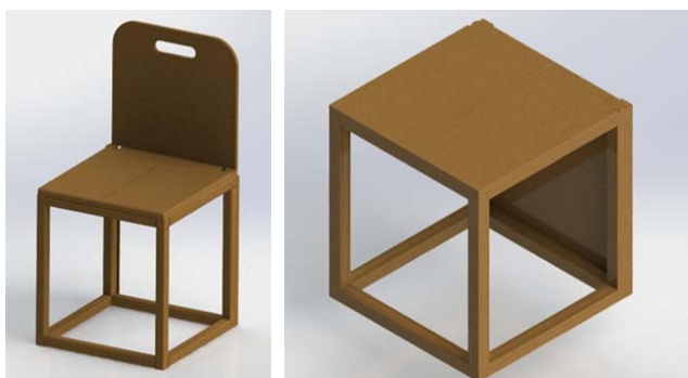
Slika 3. 3D model stolice i stolića koji nastaje spuštanjem naslona stolice, urađeni u SolidWorksu [4]
