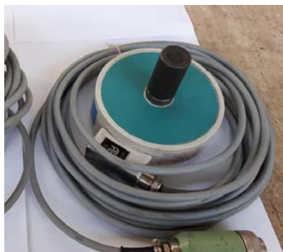
Ćelija za silu 20 kN, ser. br. 030430105 Proizvođač:HOTTINGER BALDWIN MESSTECHNIK, Germany Tip: Z4 Mjerno područje: 2 kN-20 kN Prva kalibracija: PTB Njemačka Zadnja kalibracija: BAM Berlin
