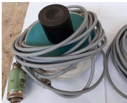
Ćelija za silu 100 kN, ser. br. 024630088 Proizvođač:HOTTINGER BALDWIN MESSTECHNIK, Germany Tip: Z4 Mjerno područje: 10 kN-100 kN Prva kalibracija: PTB Njemačka Zadnja kalibracija: Lims, Zagreb
